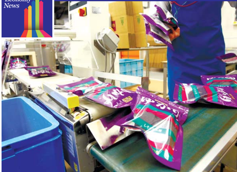
機械で袋詰めされた「ゆかり」。品質が満たされない商品は、自動的に分別される＝広島市中区の三島食品広島工場、いずれも上田幸一撮影
