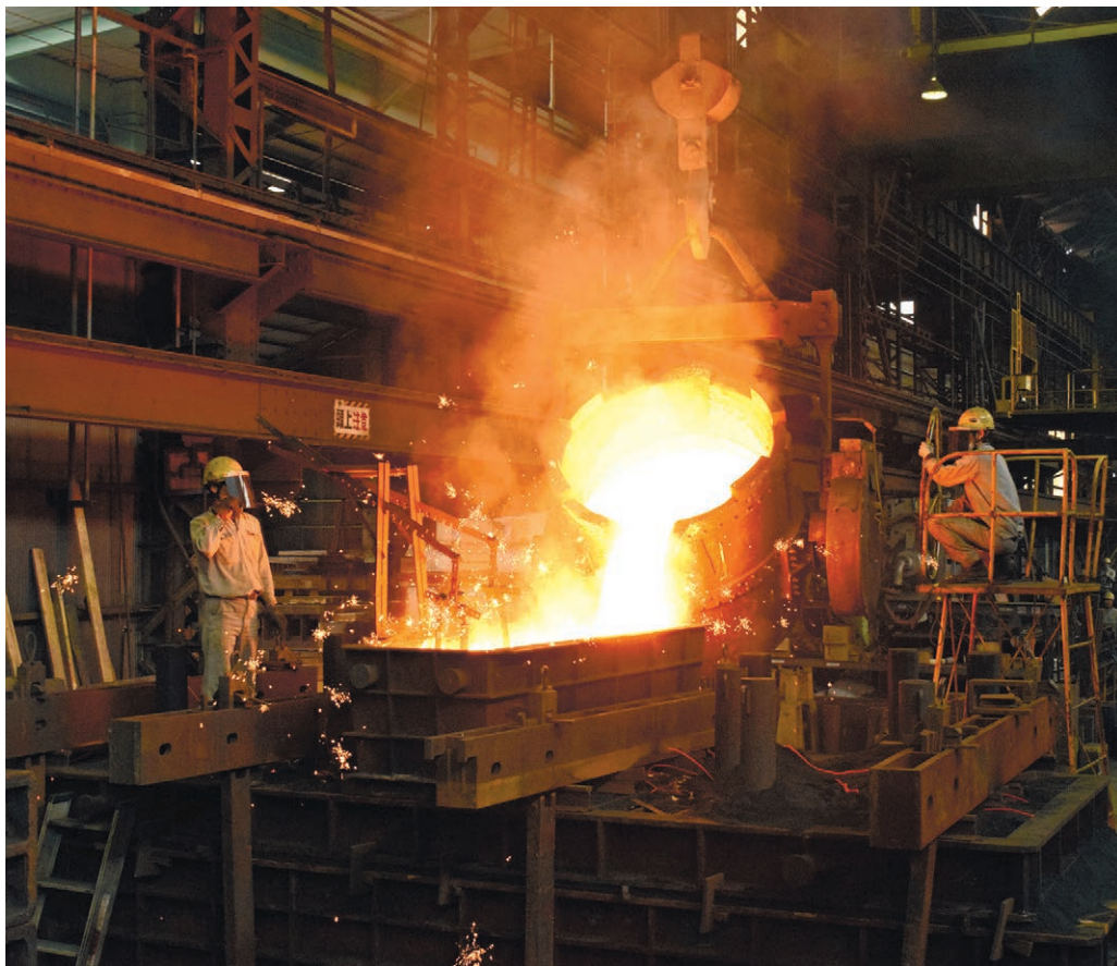
鑄型に溶けた鉄を一気に流し込む作業。線香花火のような火花が散った ＝いずれも広島市安佐北区の大和重工
