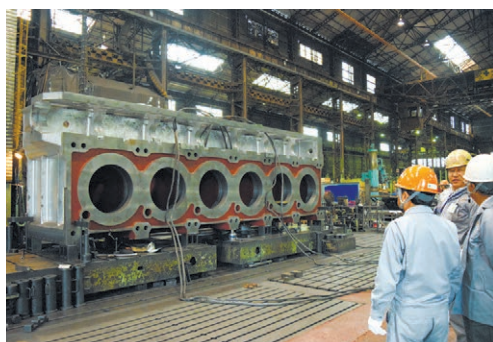
巨大な船のエンジン部品（左）から、かまど（右）や五右衛門風呂まで様々なものを鑄造している
