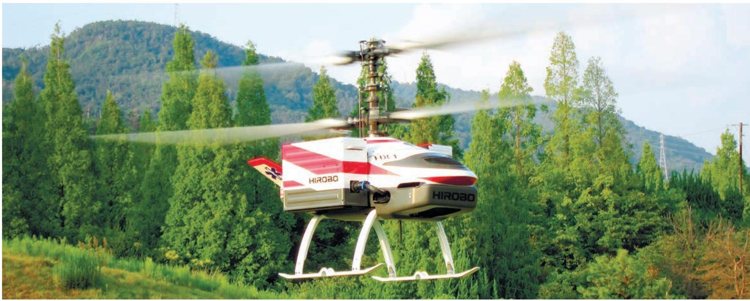
開発中の電動無人ヘリコプター「HX-1」。完全自律飛行が可能で、血液搬送や放射能検知での活用を想定している=ヒロボ提供
