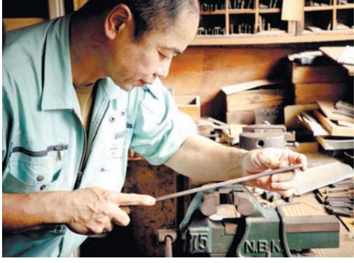
針の製造に欠かせない金型を加工するチューリップの迫誠志・加計工場長
