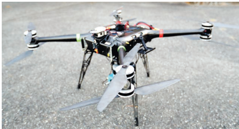
2枚のプロペラが計4カ所に配置されたドローン=いずれも上田幸一撮影
