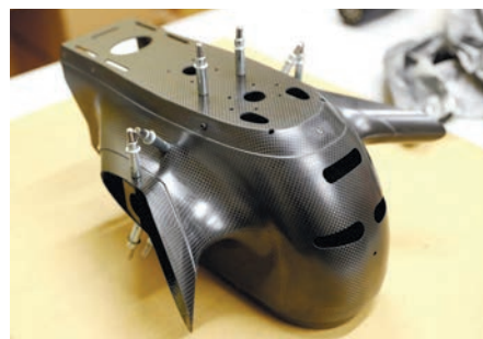
ドローン本体やフレームはカーボン製で、自社で加工している
