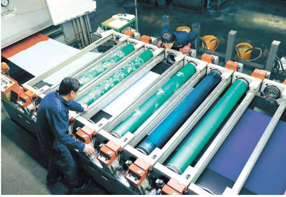
抜染作業では、ロールに描かれた模様がずれていないか慎重に調整していた。いずれも上田幸一撮影
