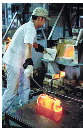
トーホーのグラスビーズ工場。原料のガラスを溶融炉から取り出し、熟練の職人が成形のタイミングを見極める＝同社提供
